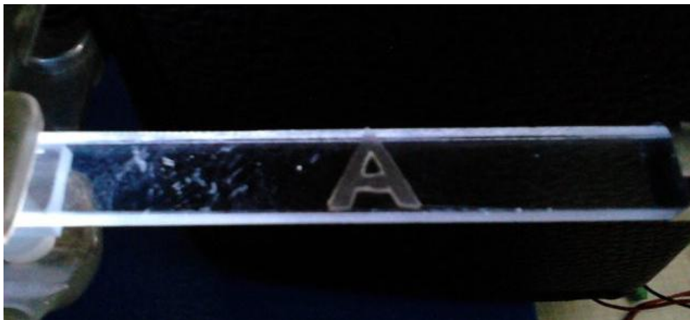
Рисунок 20 – Буквенный символ, располагаемый на подложке из оргстекла; визуальное восприятие – темный, оптический контакт отсутствует.
