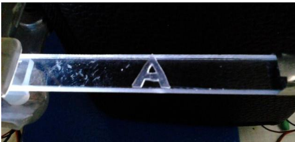
Рисунок 21 – Буквенный символ, располагаемый на подложке из оргстекла; визуальное восприятие – освещенный, оптический контакт присутствует.
