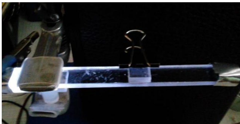
Рисунок 5 – Фотографии образца исследуемой пленки, приведенной в контакт со светопроводящей пластиной; а) – до приложения механической нагрузки, б) – после.
