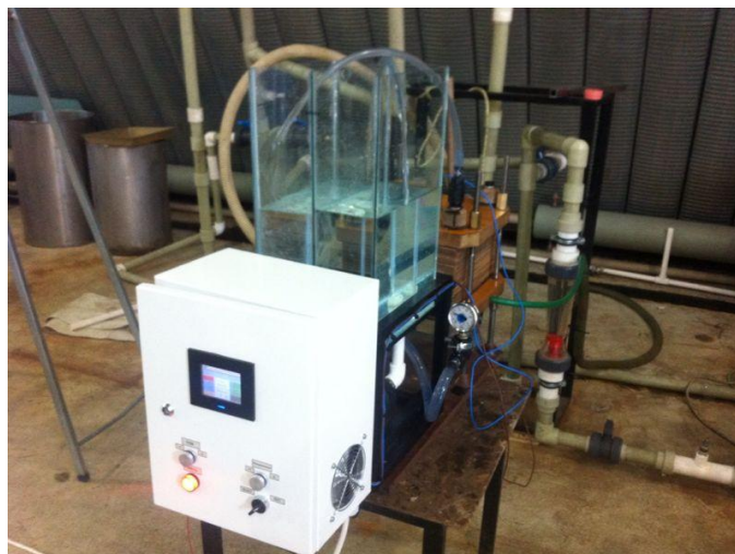
Рисунок 2 – Пилотная электродиализная установка производительностью 50 л/час
