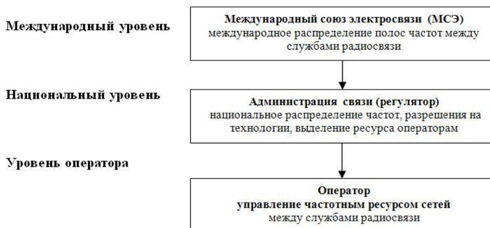
Рисунок 1 - Уровни распределения радиочастотного ресурса
