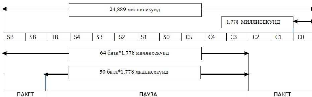
Рисунок - 2. Схема формата протокола передачи данных.
