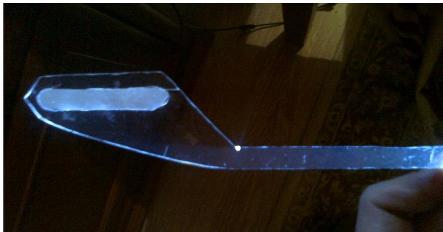
Рисунок 4 - Фотография элемента индикаторной панели при торцевом освещении
