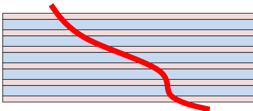
Рисунок 7 – Формирование сложной «траектории движения» максимума ионизационной волны в плоскости изображения, создаваемого фокальной системой
