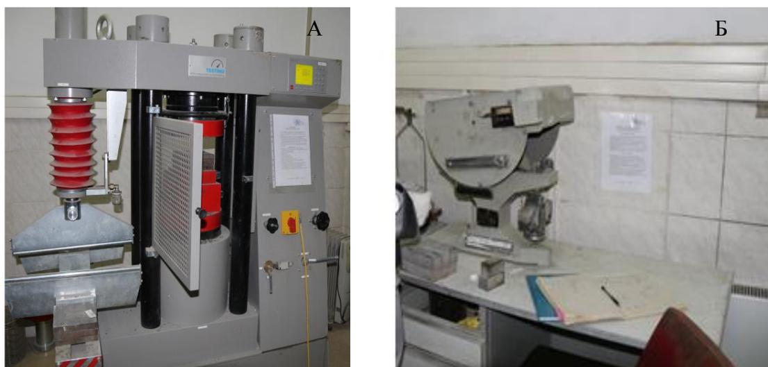
Рисунок 1 – Испытательные установки на сжатие (А) и изгиб (Б)
