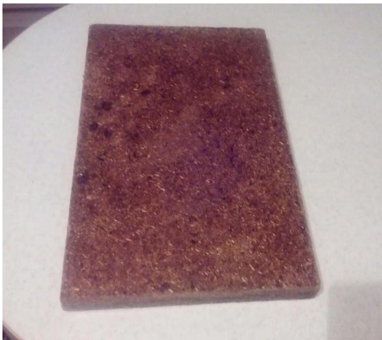
Рисунок 5 – Образец плитного материала, полученного на модернизированной пресс-форме
