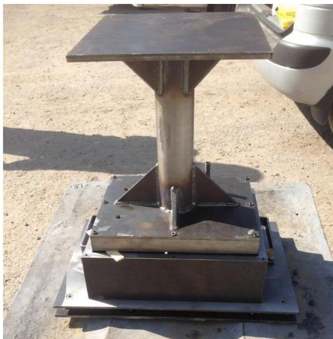
Рисунок 3 – Модернизированная пресс-форма в сборе
