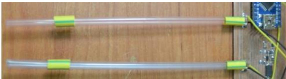
Рисунок 2 – Фотография прозрачной полимерной трубки со вставленным внутрь светодиодом, ось трубки и оптическая ось источника света совпадают
