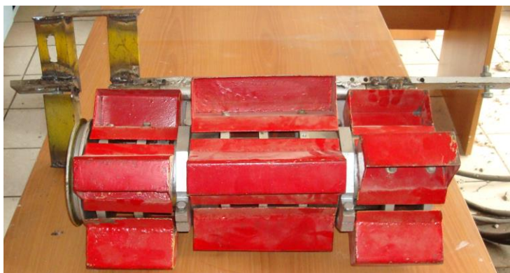
Рисунок 1 – Модель 3-х секционного роторного рабочего органа с циклоидальным движением ковшей
