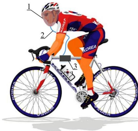
1 – сетчатая вуаль, 2 – дыхательная трубка, 3 – узел фильтрации на основе вентиляторного насоса
