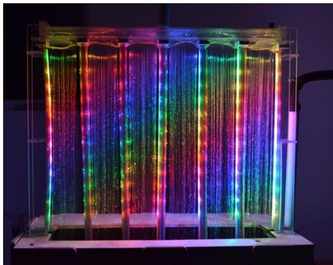
Рисунок 2 – Фотография опытного модуля медиаэкрана, обеспечивающего создание цветового паттерна за счет рассеяния света на диспергированной воде (многоцветный паттерн)
