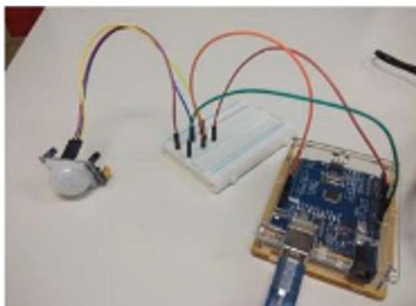
Рисунок 6 – Результат подключения ИК-датчика к Arduino
