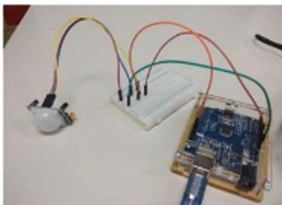
Рисунок 6 – Результат подключения ИК-датчика к Arduino
