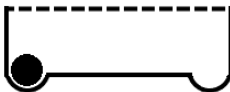
Рисунок 2 – Вариант формы одноразовой кюветы для вискозиметрических измерений (в разрезе по диаметру)
